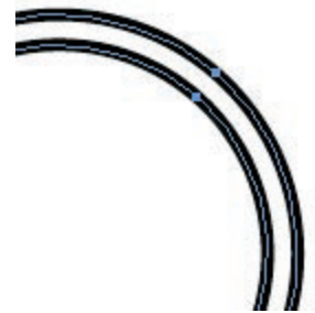
Een vector vorm bestaat uit punten die met elkaar verbonden zijn door middel van lijnen.
